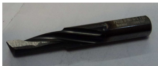
Рис. 2. Резец из твердого сплава Т15К6
