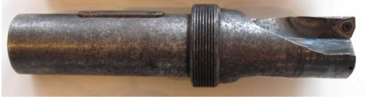
Рис. 1. Загальний вигляд збірного свердла з механічним кріпленням БНП
