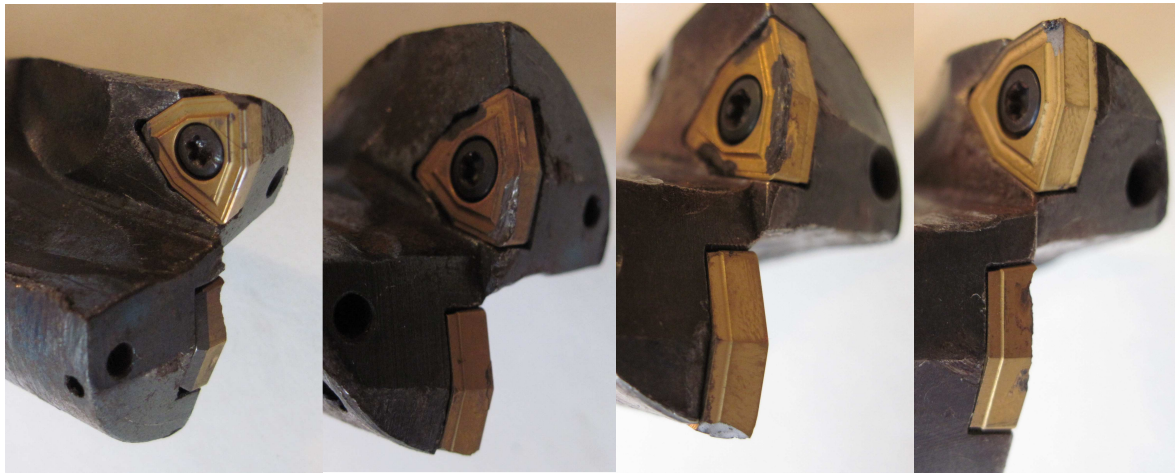
Рис. 2. Основні види пошкоджень різальних пластин збірних свердел, що виникають під час свердління залізничних рейок
