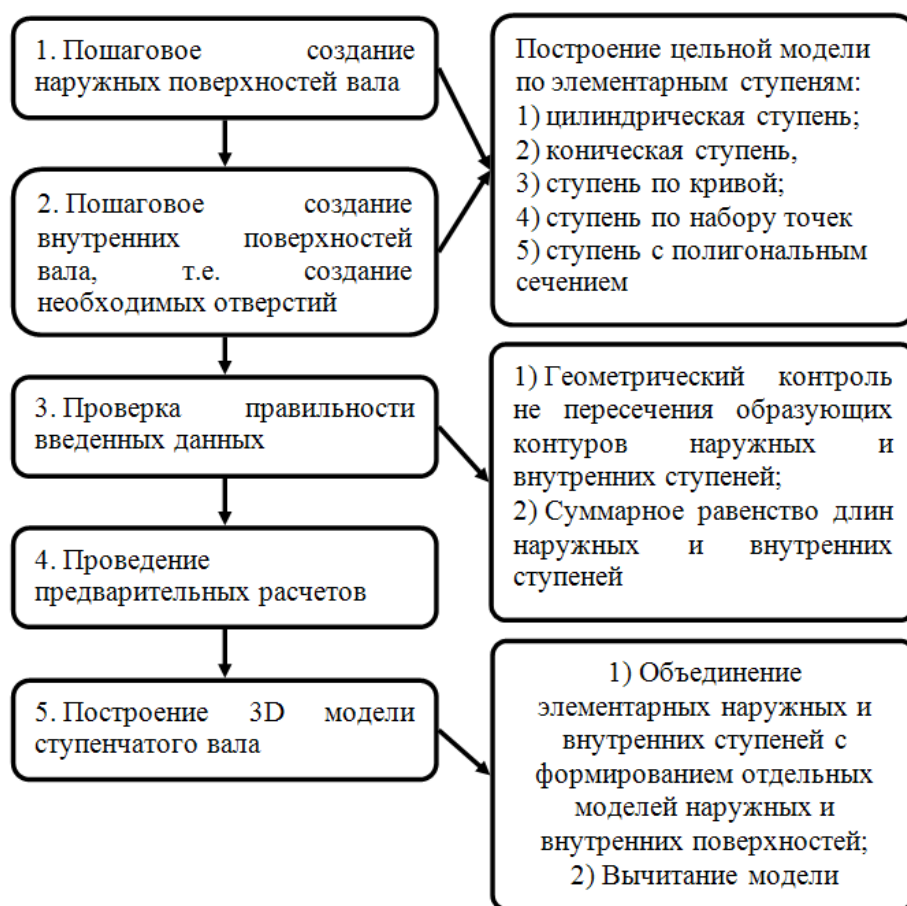
Рис. 1. Структура работы САПР ступенчатого вала
