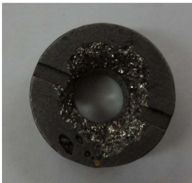
Рис. 3. Образующиеся микросколы на торцевой поверхности кольца
