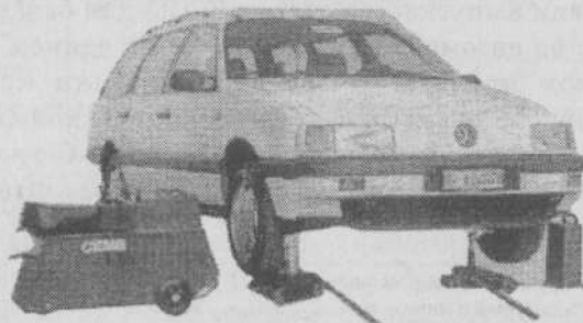
Рис. 8.9. Подкатная машина для балансировки колес легковых и грузовых автомобилей, мод. L-38 фирмы «СЕМВ» (Италия)
