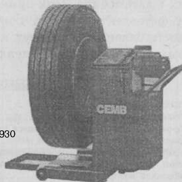
Рис. 8.8. Станок для балансировки колес грузовых автомобилей, автобусов и легковых автомобилей, мод. P-200 фирмы «СЕМВ» (Италия)
