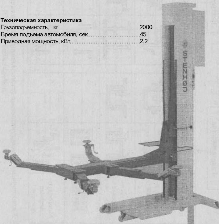
Рис. 4.7. Одностоечный напольный подъемник фирмы «STENHOJ» (Дания) мод. «Mistral»
