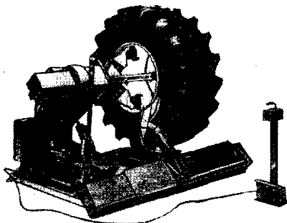
Рис. 10.12. Универсальный шиномонтажный станд, модель М 70 фирмы «BEJSSBARTH» (Германия)
