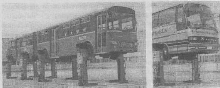
Рис. 4.15. Передвижные подъемные стойки фирмы «Hetra» (Швейцария)
