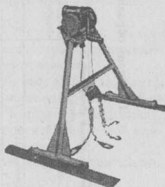
Рис. 4.28. Приспособление для снятия и установки ГМП автобусов ЛиАЗ-677, 5256, мод. П-266
