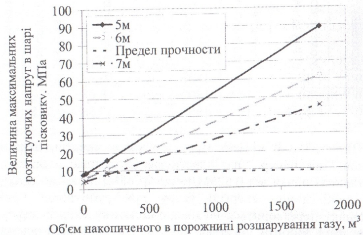
Рис. 15. Залежність розтягуючих напружень в шарі пісковику від об'єму накопиченого в порожнині розшарування газу
