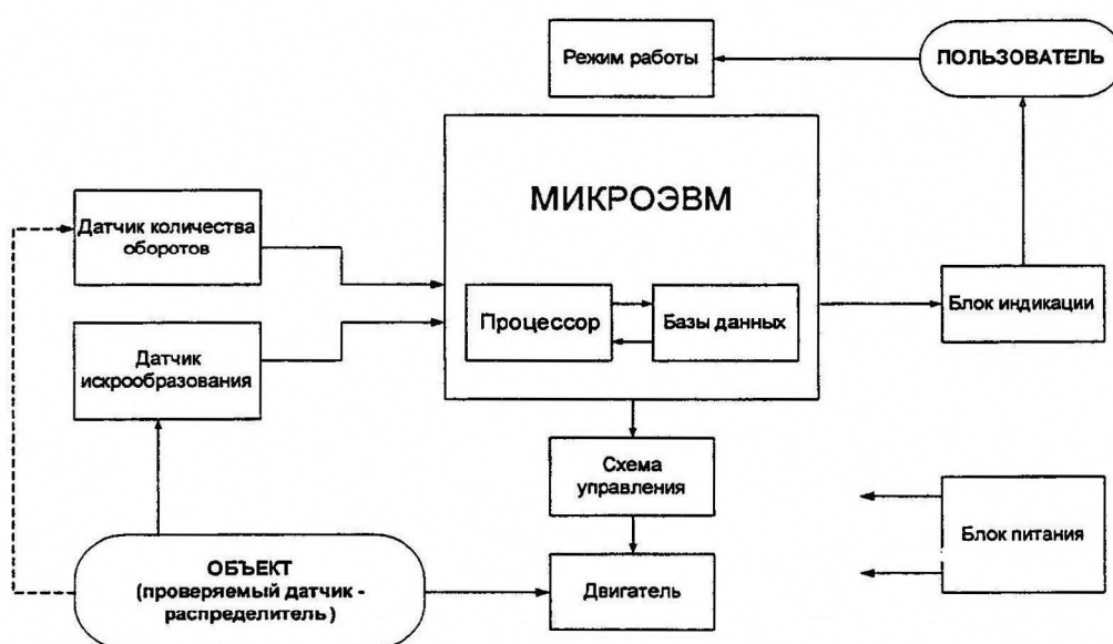
Рис. 2. Структурная схема цифрового стенда контроля датчиков-распределителей
