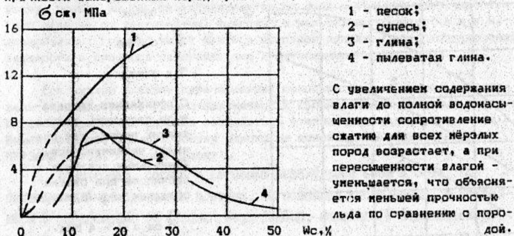
Рис.7.1.5. Зависимость предела прочности \sigma_{сж} от суммарной влажности.
