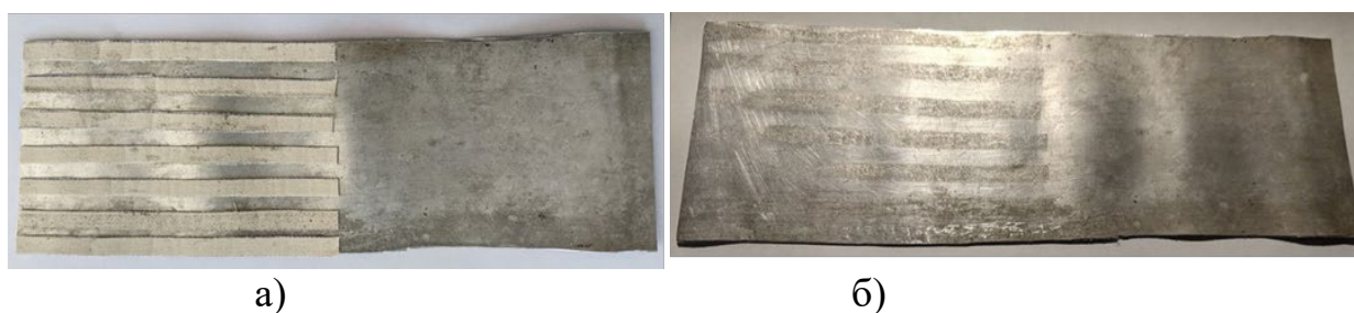
а - внешний вид коробоватого образца до прокатки; б - внешний вид образца после прокатки
