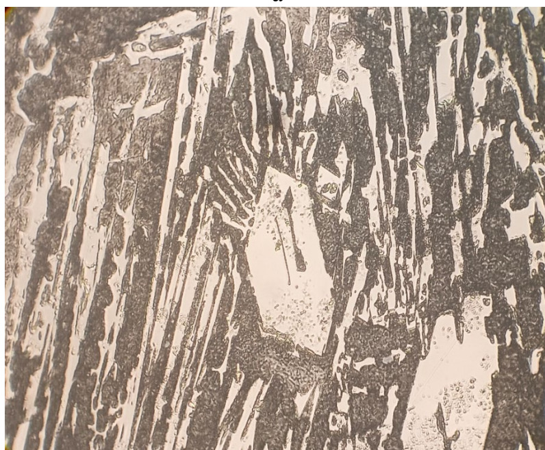
Рисунок 1 – Микроструктура чугунов ИЧ290Х12 (а) и ИЧ280Х28Н2М2 (б), \times 500
