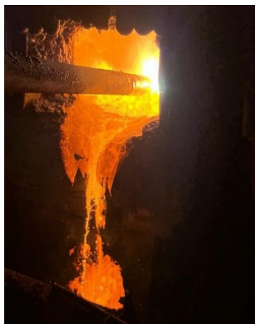
Рисунок 2 – Ввод кислорода оконной мультифурмой
