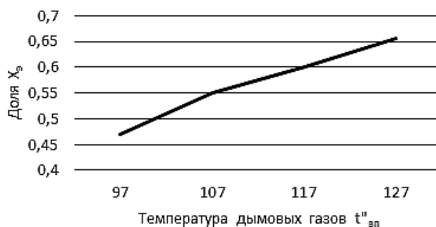
Рисунок 1 — Зависимость доли продуктов сгорания на экономайзер от их температуры после воздухоподогревателя
