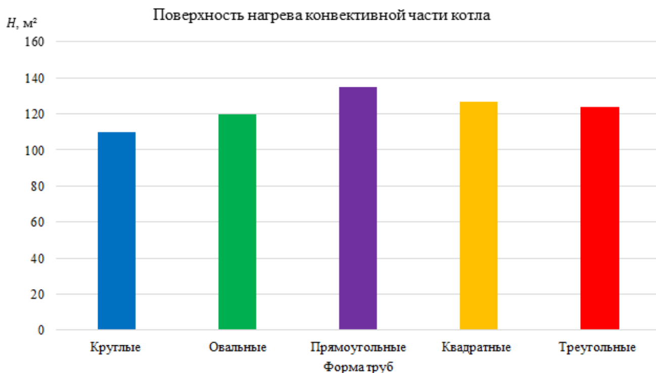
Рисунок 1 – Поверхности нагрева конвективной части котла ТВГ-8М для различных форм труб
