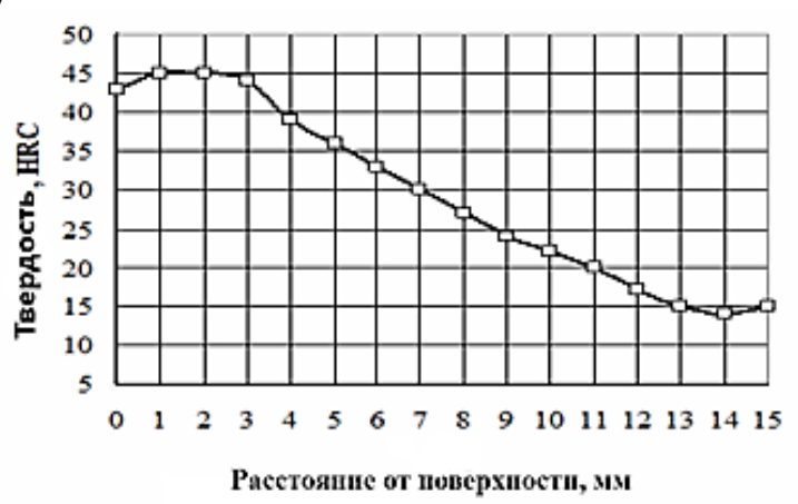
Рисунок 1 – График распределения твердости по сечению образца из стали 40Х после наплавки
